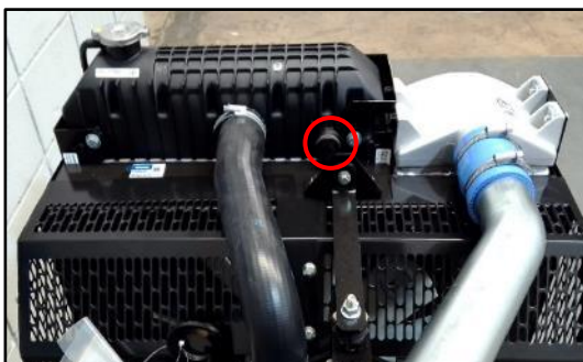
Predisposição para instalação de sensor de nível Rosca: 1/2" NPSI
